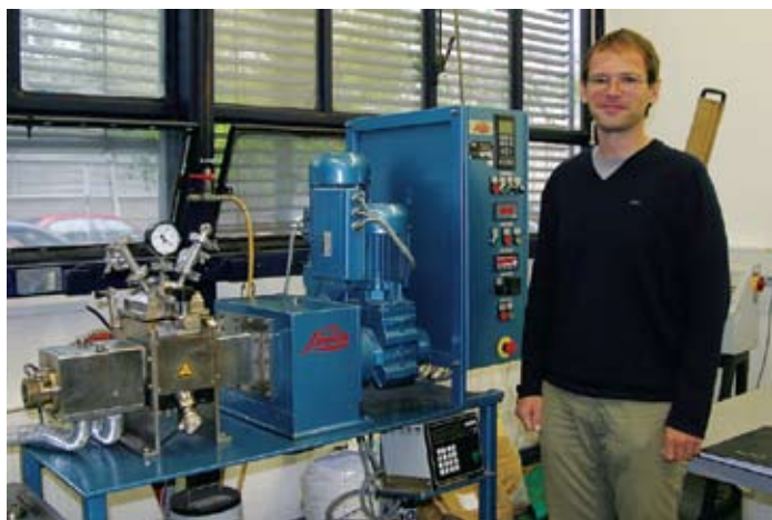
Naprava za pripravo plastomagnetnih kompozitov na osnovi kemičnih magnetnih materialov in kovinskih magnetnih materialov
