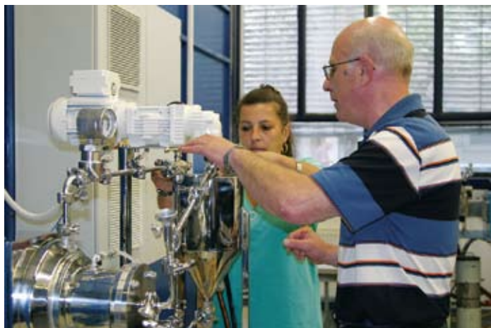
Naprava za pripravo končnih disperzij premaznih sistemov z integriranimi nanodelci
