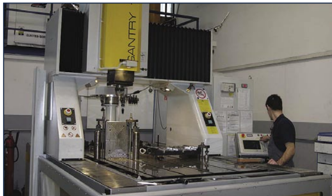
Potopna erozija, pravijo Livovi orodjarji stroju za erodiranje zahtevnih oblik. Na njem med drugim izdelujejo orodja za sanitarno plastiko
