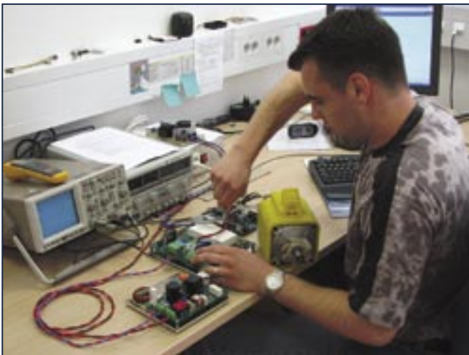
Preizkušanje metod za vodenje motorjev
