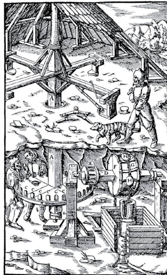
► Obojeustransko kolo za dviganje jamske vode in rude, Georgius Agricola: De re metallica, 1556
