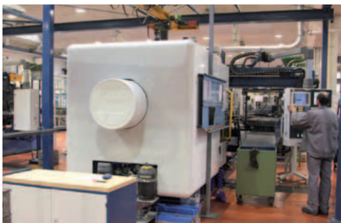
Nov Biraghi, ki je oktobra zapustil Kolektorjevo Strojogradnjo, že služi svojemu namenu. V Diviziji B Kolektor Sikoma z njim brizga jo prešno maso za poženi/ustavi oziroma start/stop komutatorje
