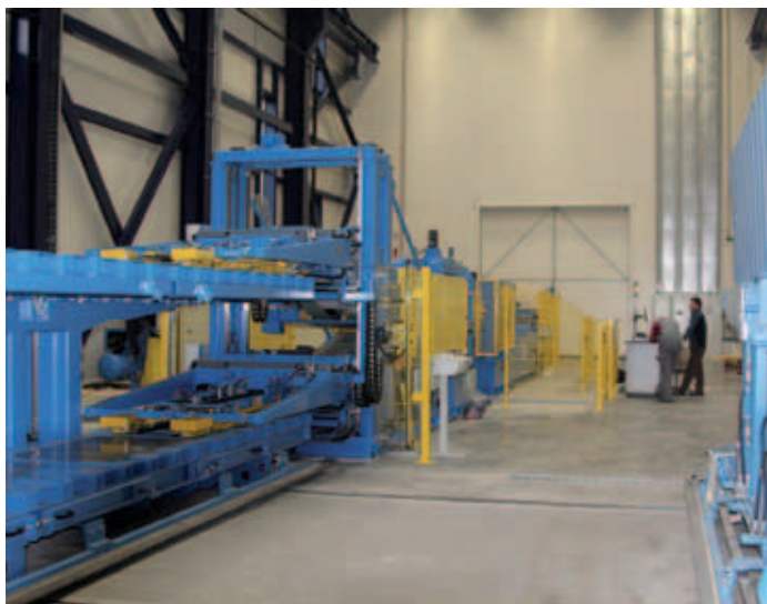
Stroj za razrez transformatorske pločevine sta delavca proizvajalca pripravljala za preizkusni zagon
