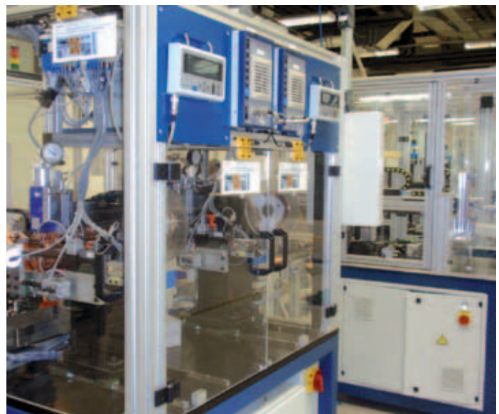
Linija za izdelavo connection unit enot, ki med drugim nadomeščajo tudi hidravlični servo ojačevalnik volanskih sklopov, kakršne poznamo sedaj, saj se vključuje le po potrebi in ni stalno pod pritiskom
